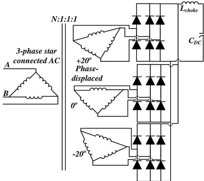
Fig. 1.3(d) Transformer rectifier unit using 18-pulse rectifier structure [8]
